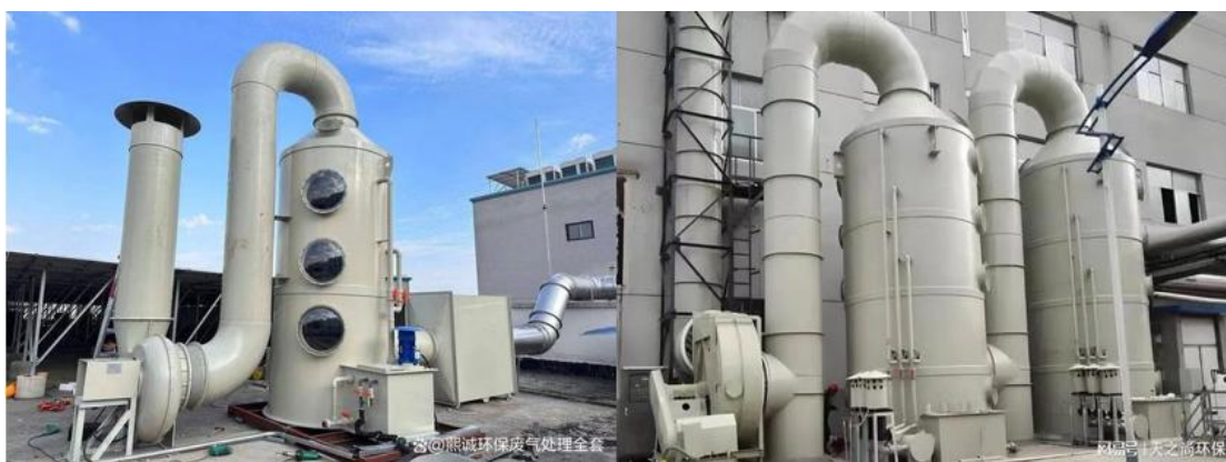
图3 新型废气吸收装置
