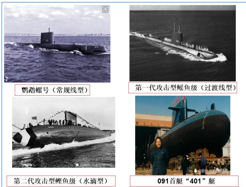
图 1 四代核潜艇外形的变化
