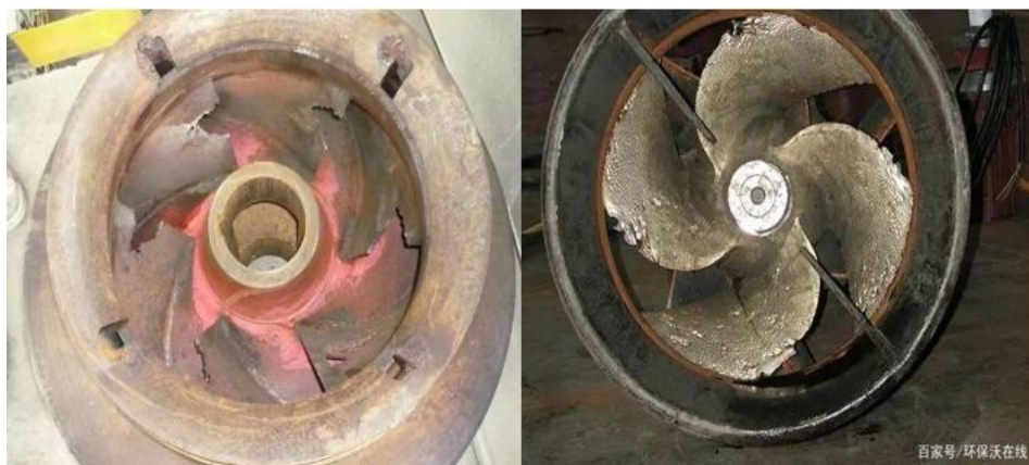
图 1 离心泵的叶轮汽蚀
