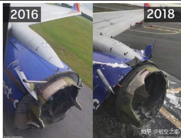
左侧为 2016 年西南航空 3472 号航班，右侧为 2018 年西南航空 1380 号航班，破损发动机对比图
