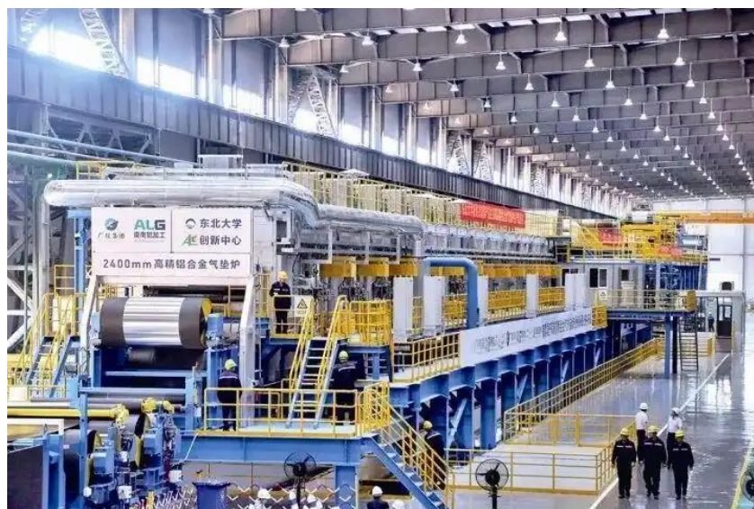
图 1 首台国产自主研发气垫式连续热处理生产线。 记者黄维业 摄 联合开发
