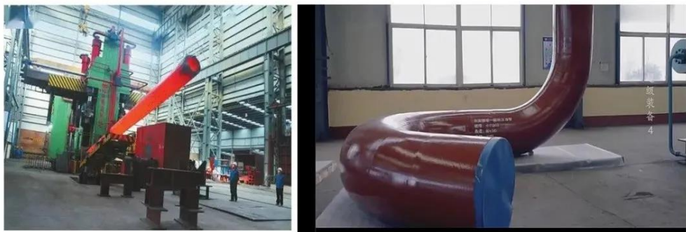
核安全：5万吨垂直挤压机+13m长大直径无缝钢管 保障了我国在核电、舰船、航空航天等领域的自主地位！
