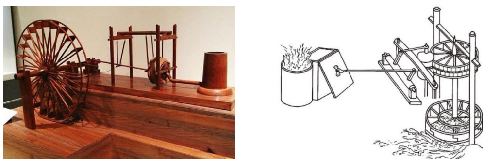
图 13 汉南阳太守杜诗发明冶铸鼓风用的“水排”
