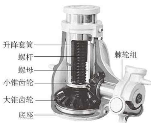
图 5 螺旋千斤顶
