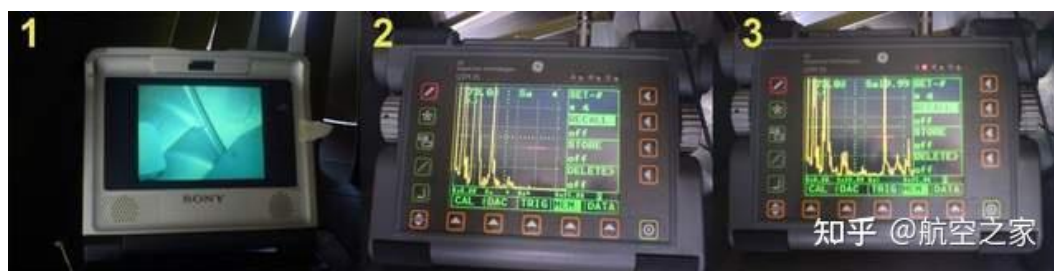
超声波检查发动机叶片示意图
