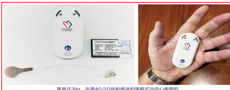
重量仅 36g，内置 4G/5G 传输模块的穿戴式动态心电图机
